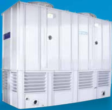
**AUSSENVERKLEIDUNG** Diese besteht aus selbsttragenden Blechplatten aus verzinktem und mit Karbonium behandeltem Stahl. Diese werden so geformt, damit sie anhand verzinkter Schrauben, Muttern oder Bolzen problemlos zusammengefügt werden können. Dann werden sie versiegelt. Eine perfekt abgedichtete Luke ist vorgesehen, um Inspektionen im Turminnenen vornehmen zu können.
