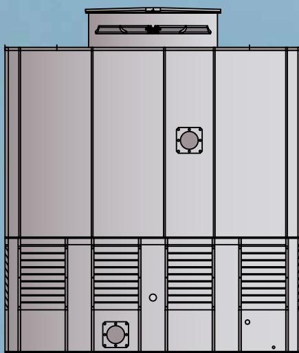
Nelle installazioni più semplici, comunque dove sia possibile localizzare la torre nel punto più alto, è possibile installare l'apparecchiatura completa del proprio bacino di raccolta acqua.
